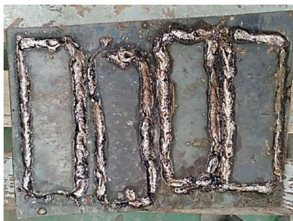
Рис. 11. Пример внешнего вида швов соединения в нахлест
