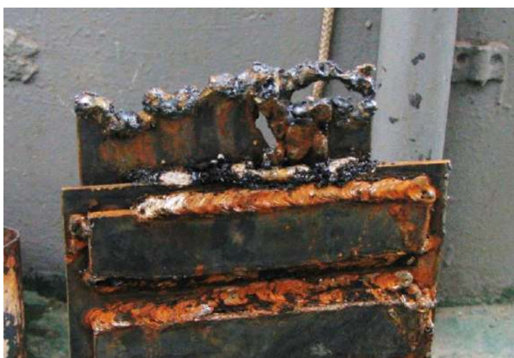
Рис. 12. Рез произведённый трубчатым электродом для экзотермической резки ЭТС-1
